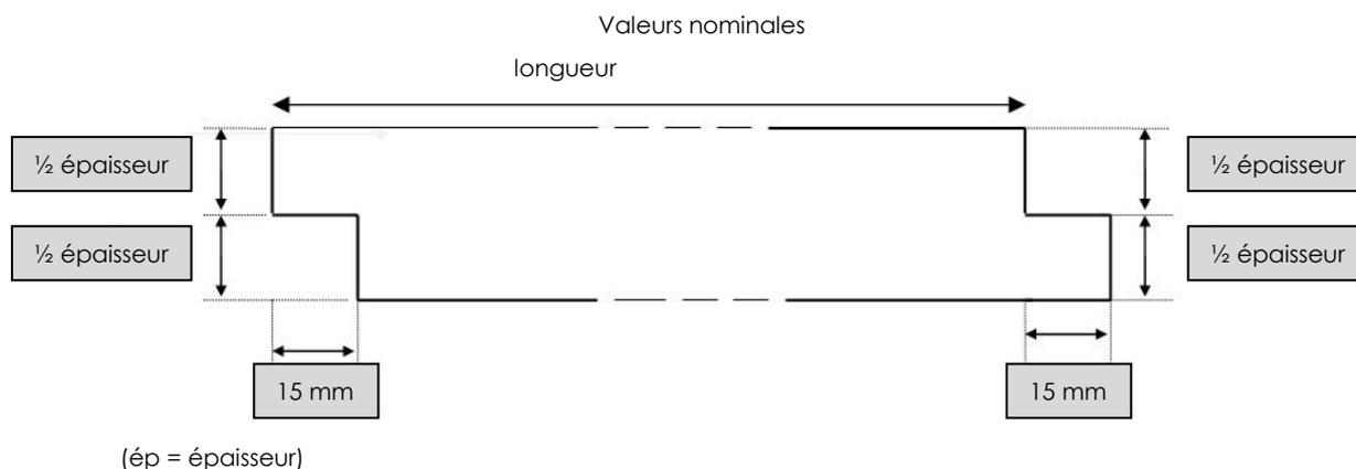
**Figure 1 (b) : Rainure et languette**
